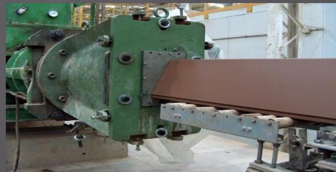
Ещё одно направление компании - это производство изделий из керамического гранита. Способ производства та же экструзия, и это даёт всё те же преимущества, имеющие место при производстве клинкера.
